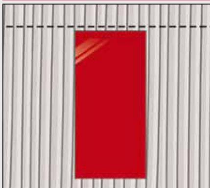
La posa di rivestimenti ceramici con peso superiore alla norma in applicazioni verticali richiede adesivi che consentano facilità di lavorazione, ottima resistenza allo scivolamento e una sicura adesione finale.
